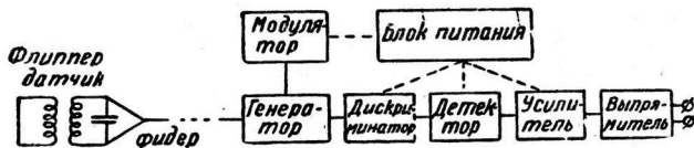
Рис. 1. Общая схема катодного прибора (объяснение в тексте).
