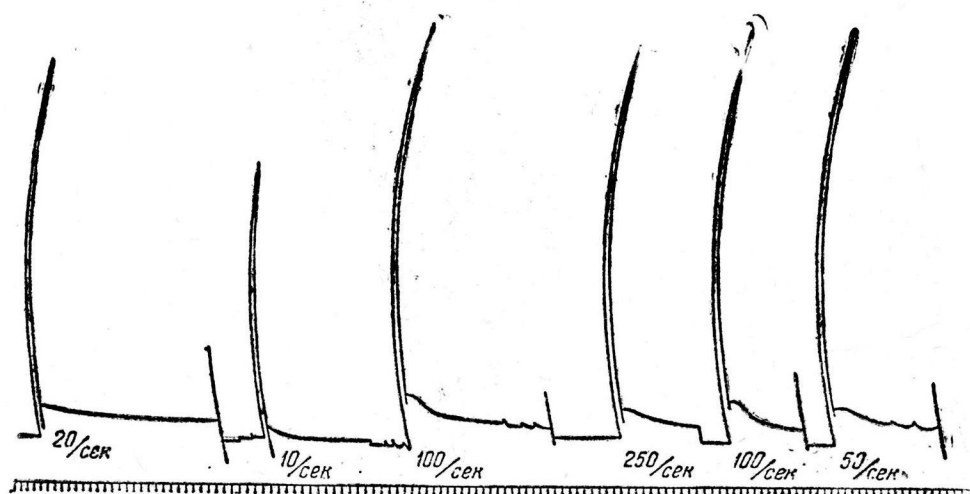
Рис. 3. Влияние частоты раздражения. Сила раздражения (р. к.) во всех случаях равна 18 см, а длительность — 0.14 сек. Искожающее влияние трения отсутствует; после отведения от поверхности цилиндра и последующего отпускания рычажок возвращается к прежнему положению (см. мелкие зубчики на кривой хвоста).
